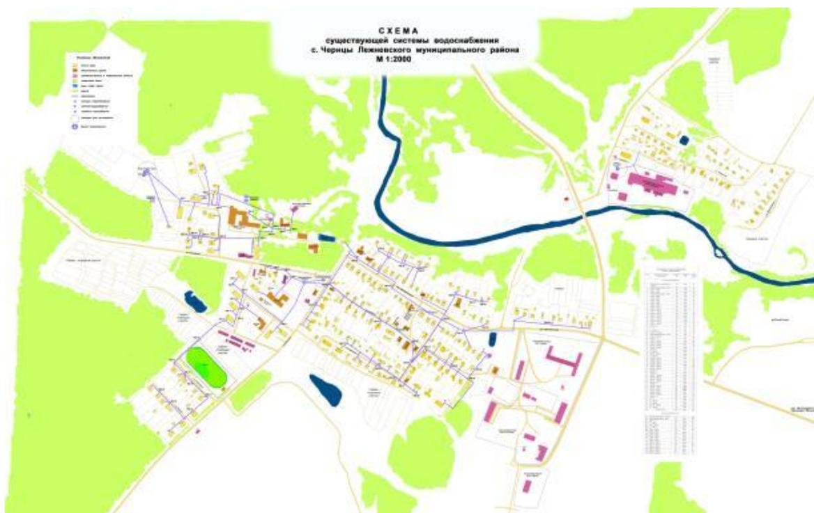
Рисунок 3. Схема водоснабжения с. Чернцы
