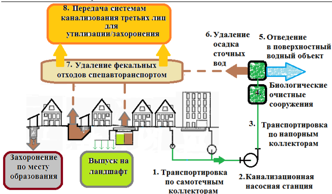
Рисунок 5 - Существующая схема структуры системы сбора, очистки и отведения сточных вод Лежневского городского поселения Лежневского муниципального района Ивановской области
